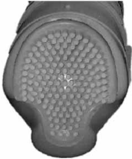
Figura 2. Vista frontal del arreglo de SQUIDs del sistema SARA.
